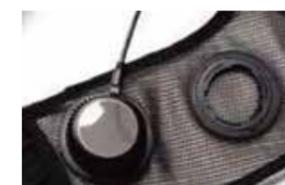
ベスト内側の接続部分にペルチェを溝に合わせてはめ込みます。
