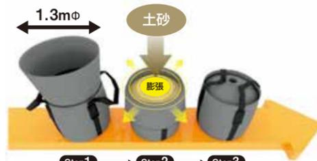
土砂の充填後は、バッグが膨張するため、テーパー式でないといけない状態に。
