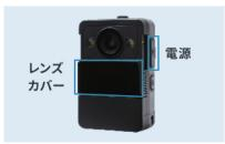
電源を入れ、レンズカバーをスライドし て、カチッと音がするまであけます。即 撮影が開始され、自動的にクラウドへアッ プされます。
