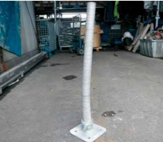
プレート部分の曲がり、変形
