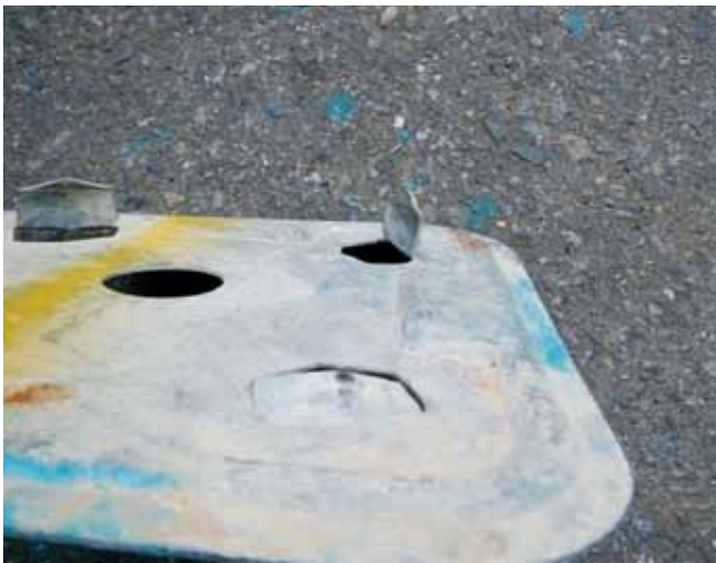
ツメ部分の変形
