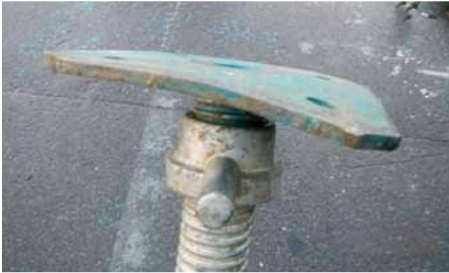
プレート部分の曲がり、変形
